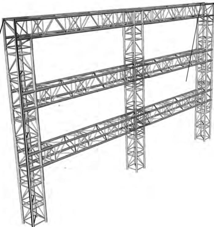
Structure composée de poutres carrées triangulées, doublement haubanée aux points hauts de chaque côté, mises en place sur tous types de terrains (sol plat).
